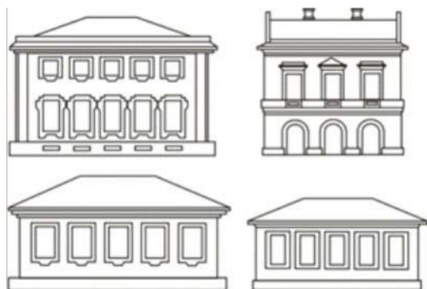
Рис. 12. «Фасадов примерных против протчих вновь строящихся городов каменным и деревянным домам». 1770-е гг. (верхний ряд: фасад каменного дома, фасад дома с лавками на первом этаже; нижний ряд: фасады деревянных домов) [1]
